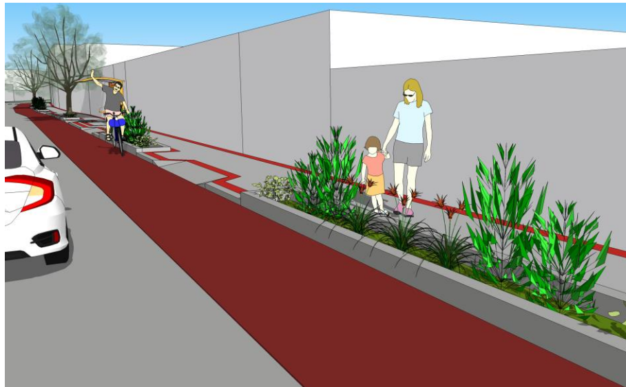
Figura 24: Canteiros pluviais na Avenida Gabriel Pandolfi.
